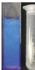
图 1 Ti 3 C 2 Tx MXene 量子点水溶液 (1mg/ml) 在 365 nm 紫外灯下的照片 (左) 和粉末的照片 (右)
